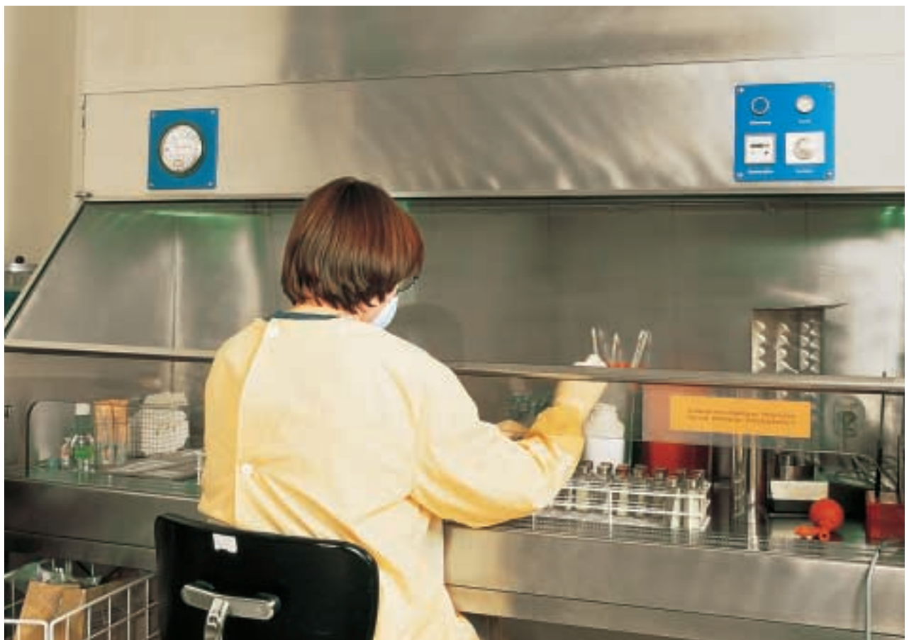
Figura 19 Laboratorio micobatterologico: cappa di sicurezza della classe 2.
